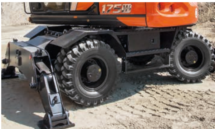
Jednoczęściowe podwozie jest wyjątkowo wytrzymałe.
