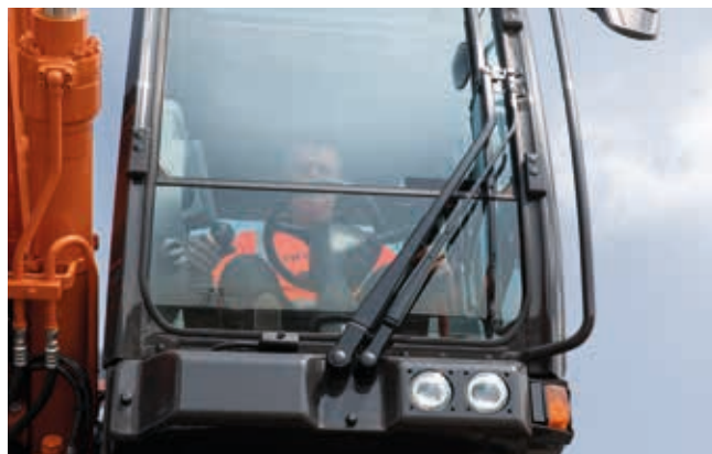
Szersza wycieraczka zapewnia lepszą widoczność.
