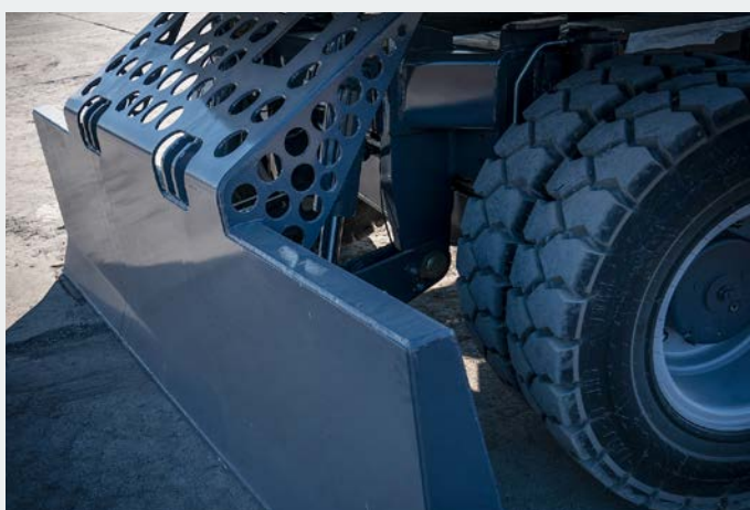
➔ Stützschild mit integriertem Zylinderschutz
