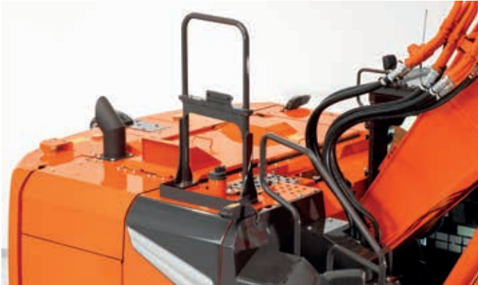
Der neue Handlauf des ZX225US/USR-7 kann für einen einfachen Transport umgeklappt werden.
