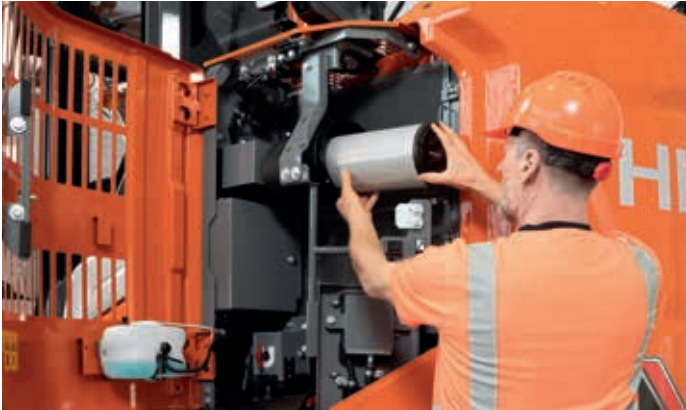
Große Wartungszugänge vereinfachen den Filterwechsel.
